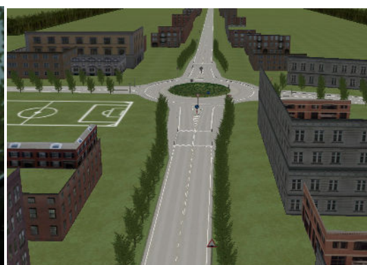
Figur 2. Rundkørsel med acceptable oversigtsforhold. Her er plantet træer i tilfarten med en indbyrdes afstand på 6 m. Højde på midterø er 1,90 m inkl. beplantning.
