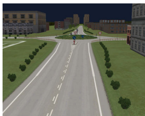
Figur 1. Eksempel på rundkørsel med middelgode oversigtsforhold. Højde på midterø er 1,5 inkl. beplantning. Højde af buske i tilfarten er 0,8 m.
