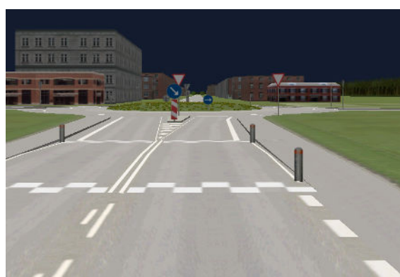
Figur 3. Rundkørsel med gode oversigtsforhold. Her er ingen beplantning langs tilfarten. Højde på midterø er 1,0 m inkl. beplantning
