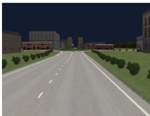
Figur 1. Eksempel på rundkørsel med middelgode oversigtsforhold. Højde på midterø er 1,5 inkl. beplantning. Højde af buske i tilfarten er 0,8 m.
