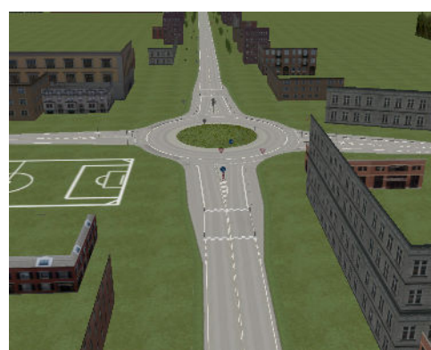
Figur 3. Rundkørsel med gode oversigtsforhold. Her er ingen beplantning langs tilfarten. Højde på midterø er 1,0 m inkl. beplantning
