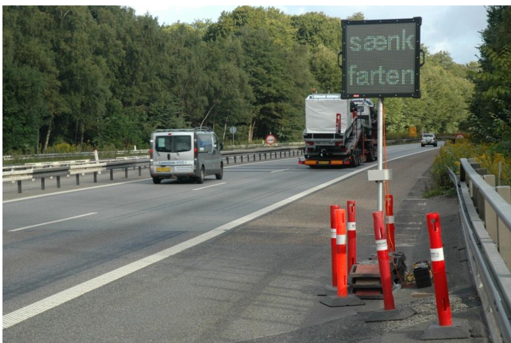
Foto 3.13: Budskabet SÆNK FARTEN vises på display, når hastigheden er for høj.
